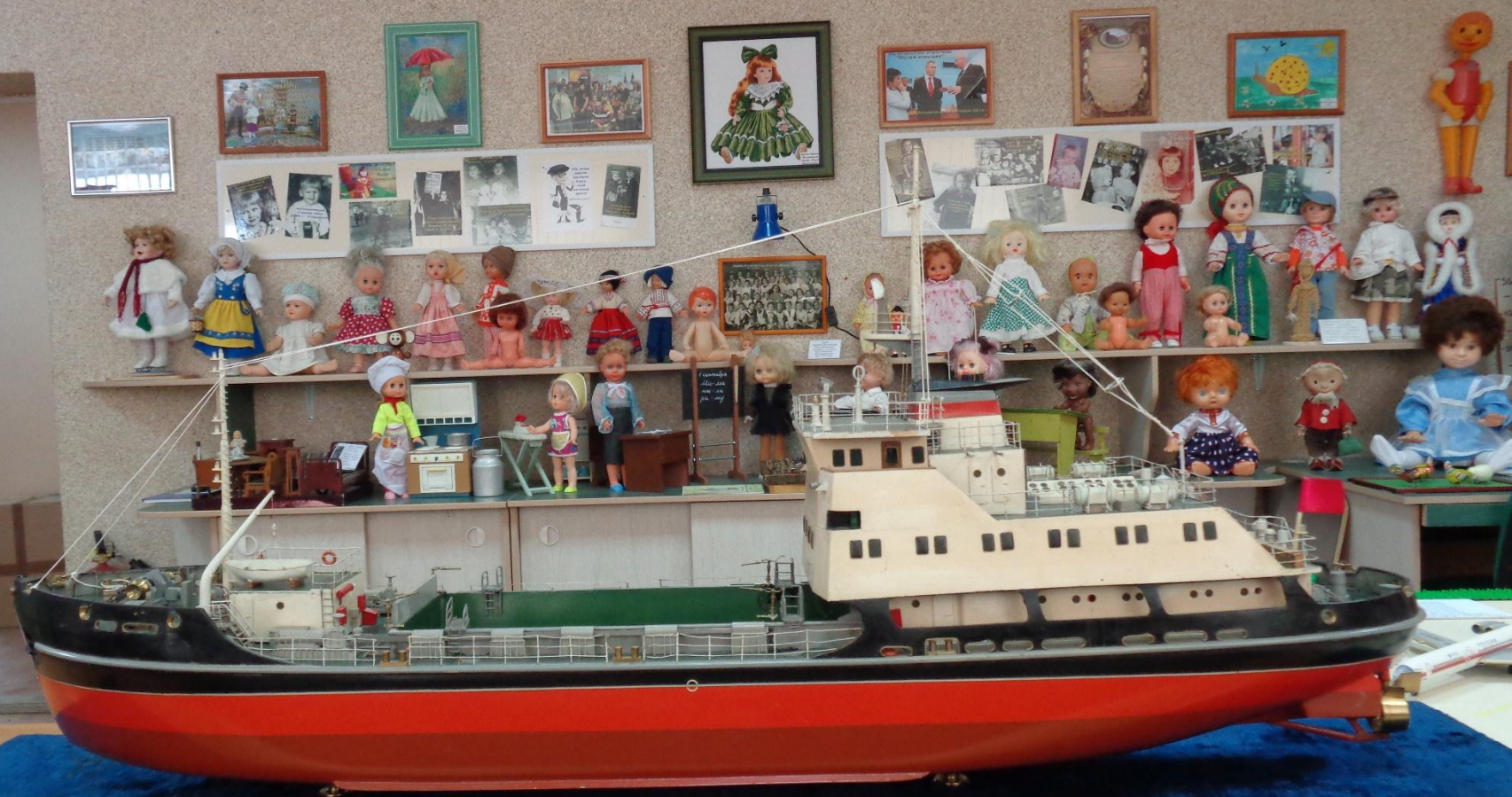
Саморазгружающаяся грунтоотвозная шаланда Судно предназначено для транспортировки грунта, извлечённого со дна водоёма земснарядом, в нужное место, где оно его самостоятельно выгружает.
